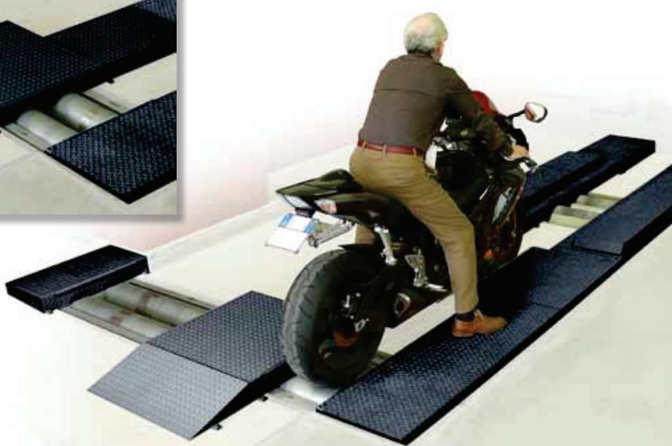
Per i veicoli leggeri a 3 e 4 ruote la Space propone diverse soluzioni garantendo la massima adattabilità della struttura all'officina. Infatti è possibile avere il banco prova velocità sulla sinistra o sulla destra, incassato oppure a filo pavimento.
