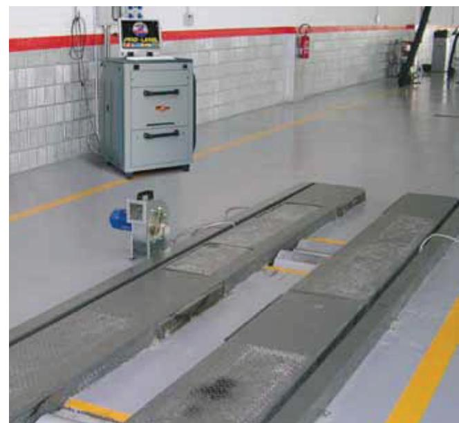
*Der Kunde kann den Prüfstand je nach Wunsch installieren: Überflur, Unterflur oder auf Sockel (optional).*
